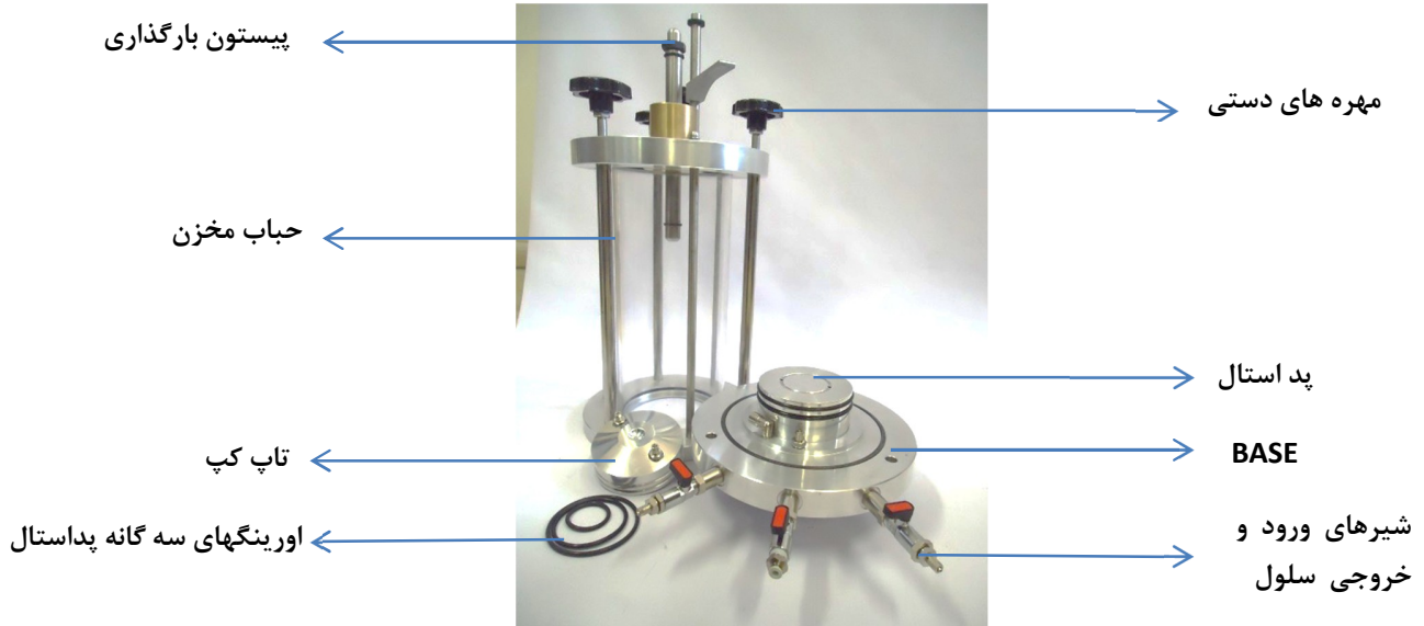
شکل ۳ مجموعه قطعات یک سلول نمونه خانواده STC 105
