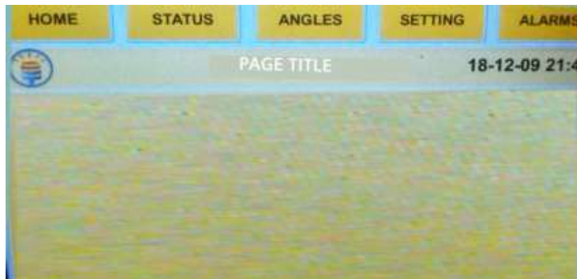
شکل ۷ قالب صفحات نمایشگر کنترل کننده FCU101
